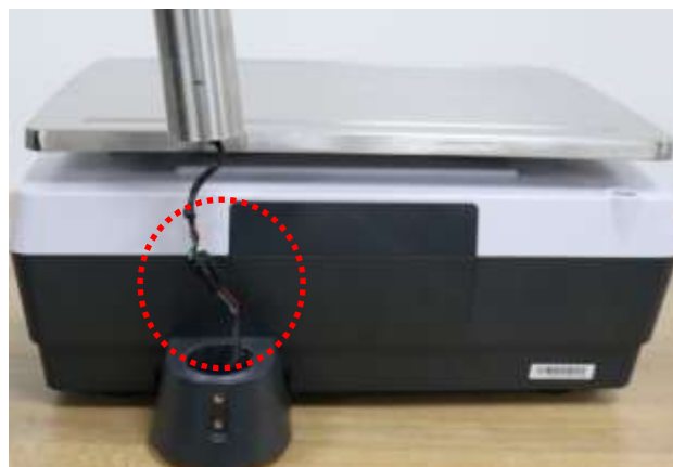
② 連接電子秤的線束與立杆元件顯示線束
