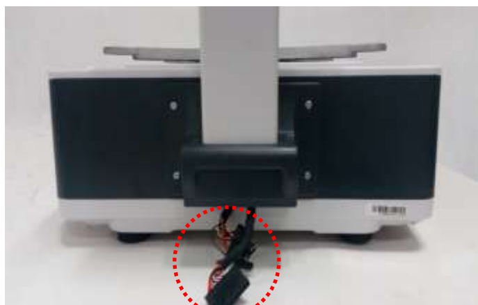
② 將立杆插入管座中，並取出線纜連接器
